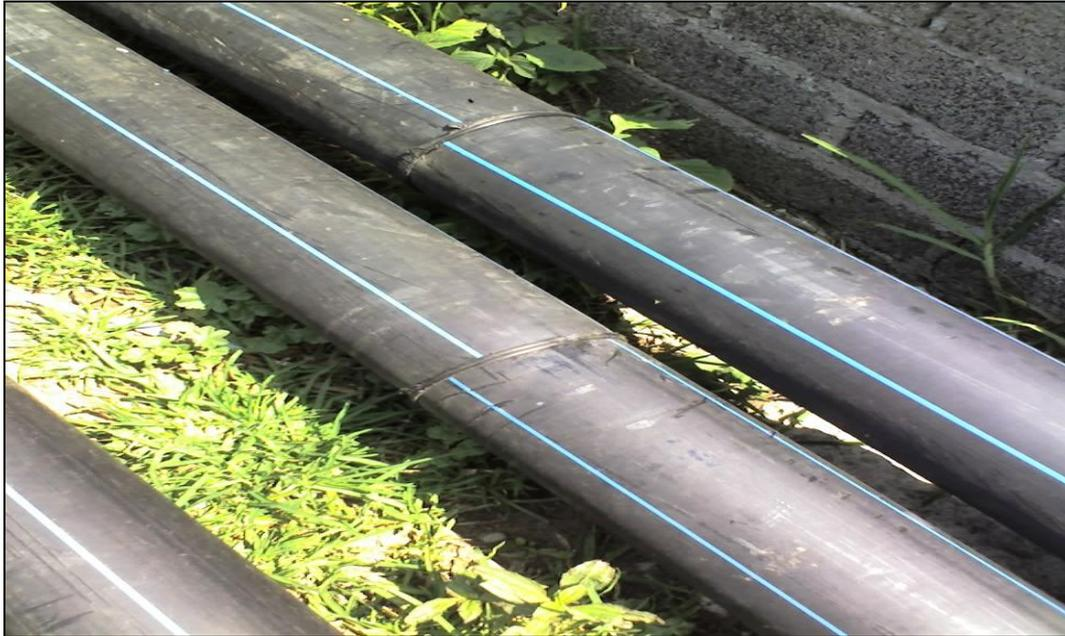
Ilustración 3 Tubo termofusionado
