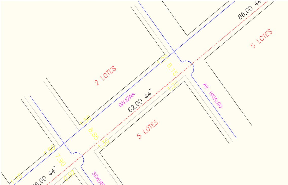
Ilustración 24 EN LÍNEA AZUL CONTÍNUA, SE MUESTRA EL NUEVO TRAZO EN GALEANA.
