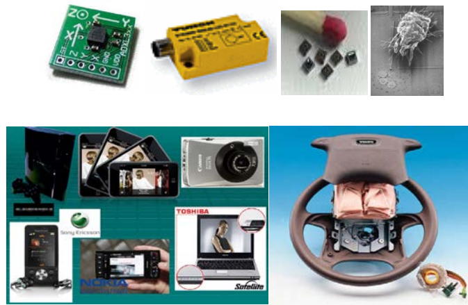
Fig. 3.15 Arriba de izquierda a derecha: acelerómetro triaxial, inclinómetro NEMS, comparativo del tamaño de sensores MEMS y NEMS contra un cerillo y un azúcar, respectivamente; Abajo aplicaciones en electrónica e industria automotriz (imágenes tomadas de internet).
