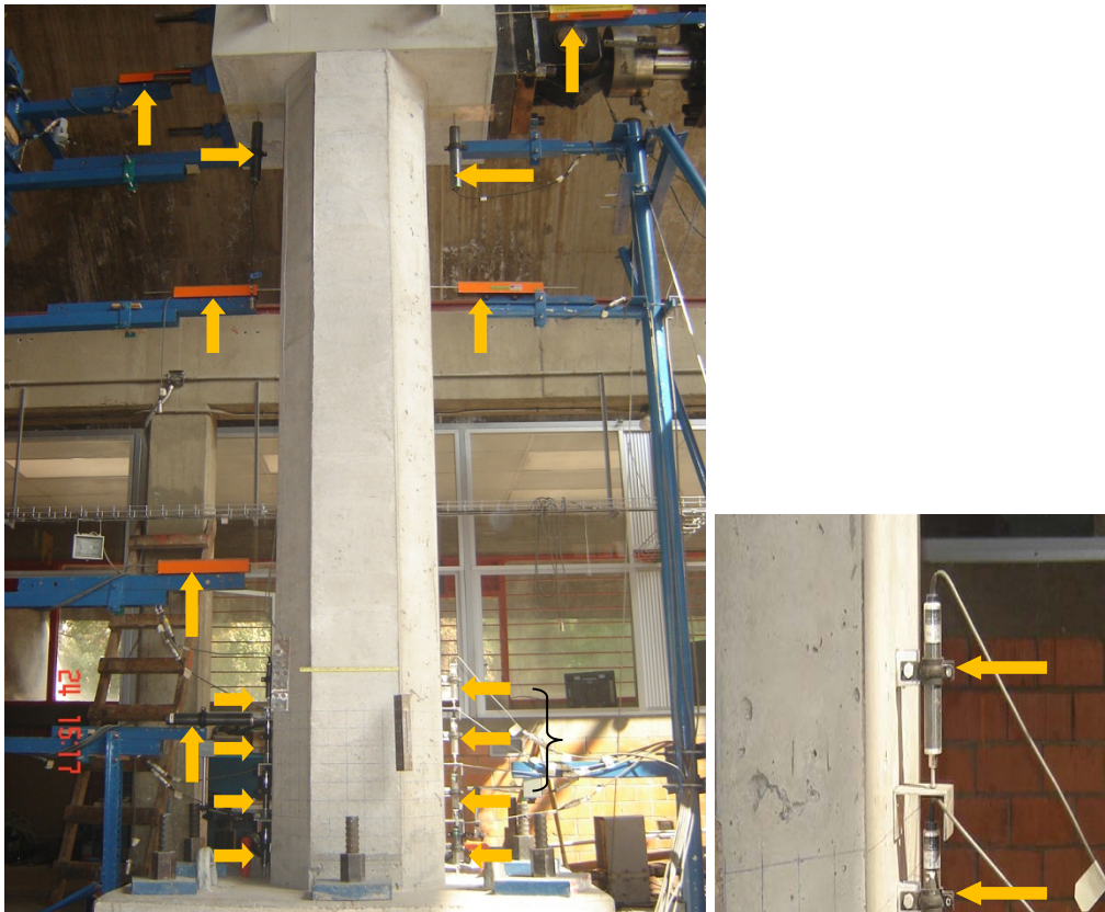
Fig. 3.34 Instrumentación en columna con sensores de desplazamiento lineal potenciométricos y de fibra óptica.
