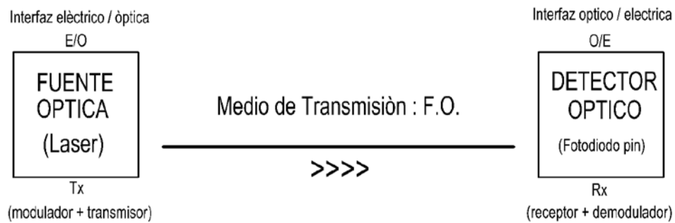
Fig. 3.21 Transmisión de datos a través de una fibra óptica (imagen tomada de la Ref.22).
