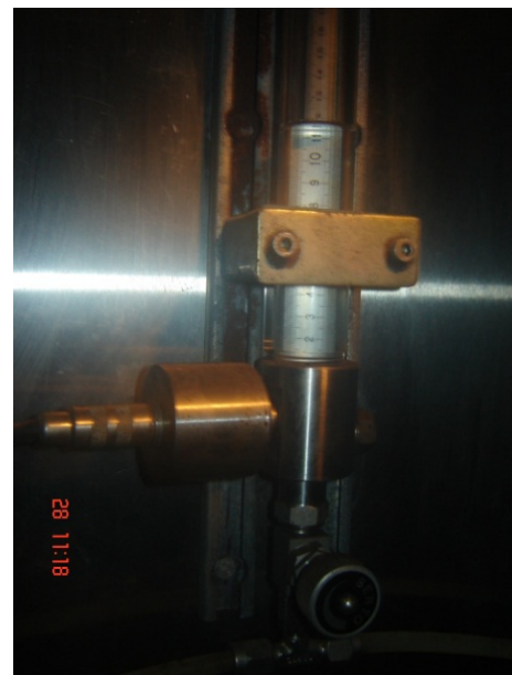
Fig. 5.11 En la imagen se puede apreciar la elevación del tirante del aceite de silicón, que permite dar seguimiento a los movimientos verticales en esta zona de la estructura.
