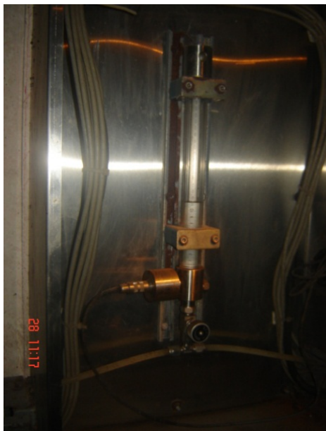
Fig. 5.11 En la imagen se puede apreciar la elevación del tirante del aceite de silicón, que permite dar seguimiento a los movimientos verticales en esta zona de la estructura.
