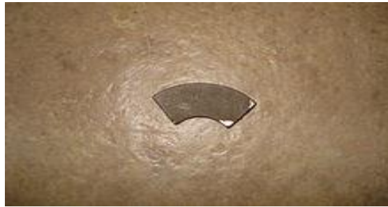
Figura No. 3.2 Imán de neodimio con lámina de níquel parcialmente removida.
