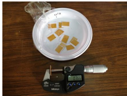
Figura 25. Medición de espesor del recubrimiento comestible de carboximetilcelulosa al 1 % con orégano en modelo de película.
