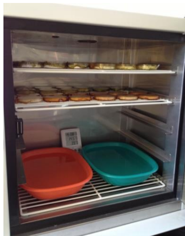
Figura 27. Cámara de ambientación durante la determinación de permeabilidad al vapor de agua.
