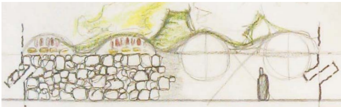
Imagen 126. Croquis y corte de la fachada al utilizar botellas de vidrio, cuya intención consiste en crear un juego lúdico de luces.
