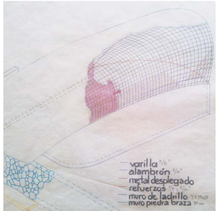
164. Armado de las bóvedas -Sistem CGL-1-
