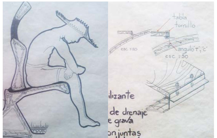
182. Detalle del armado de la banca y del ángulo para pasar de una bóveda a otra.
