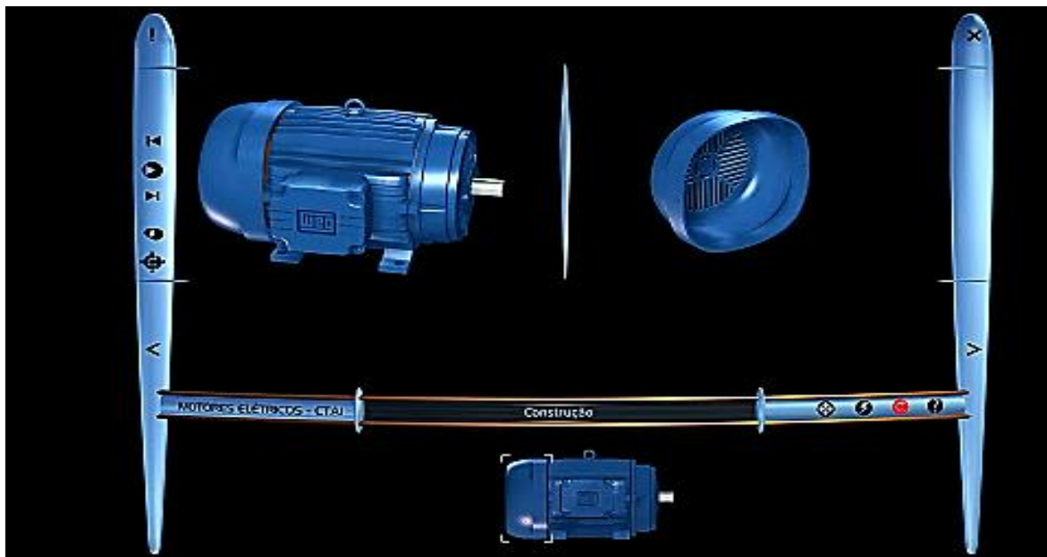
Figura. 3.12.5. Partes de un motor trifásico (tapa trasera).
