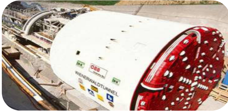
Figura 2.4 TBM para roca. Tipo escudada.
