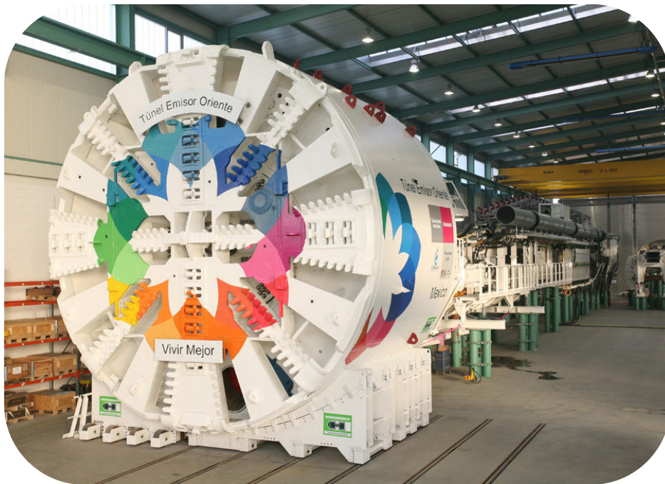
Figura 1 Presentación de la tuneladora EPB marca Herrenknecht (Túnel Emisor Oriente, México)
