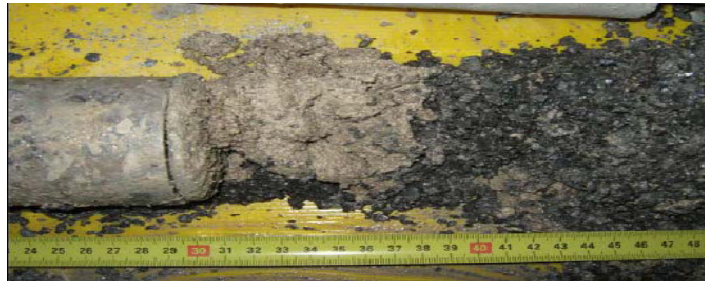
Figura 4.26 Esquema y testigo de mortero. Relleno del gap incorrecto.
