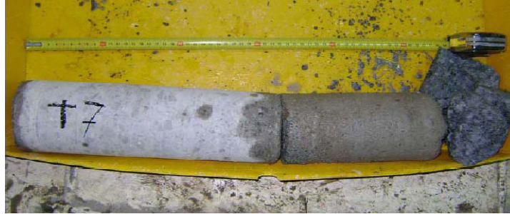
Figura 4.25 Esquema y testigo de mortero. Relleno del gap correcto.
