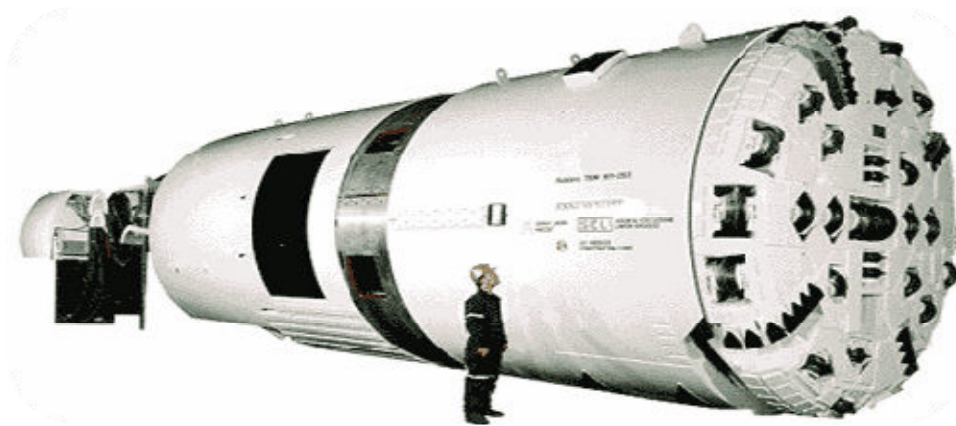
Figura 2.5 Vista en perspectiva de una TBM para roca. Tipo doble escudo.
