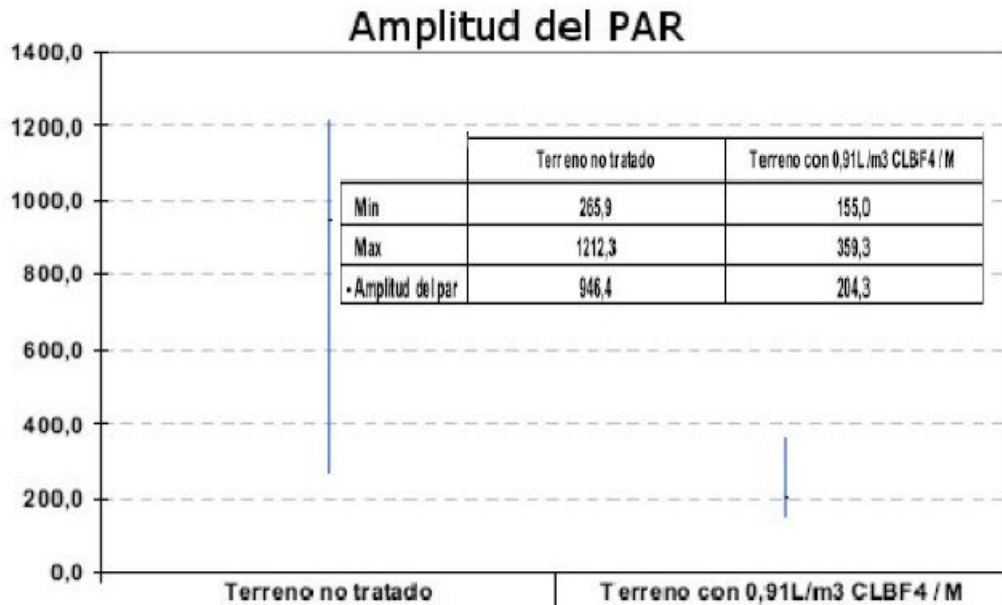
Figura 3.14 Comparación entre la amplitud del par de terreno sin tratar y tratado con una concentración de 0,91 l/m 3 de CBLF4
