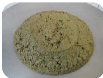
Figura 3.12. Muestra de terreno tratada con espuma
