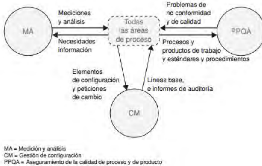
Fig. 2.8 Áreas de proceso de Soporte avanzadas
