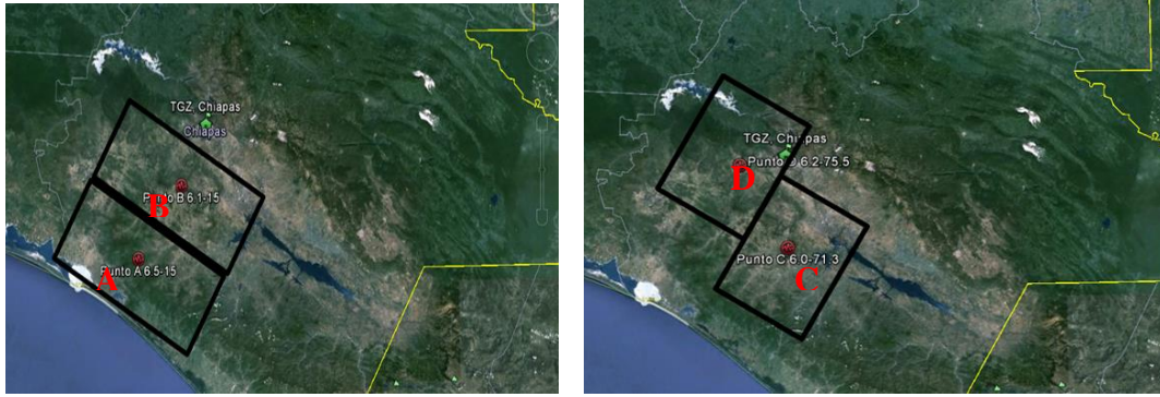
Figura 74. Fuentes sísmicas que generan peligro sísmico en Tuxtla Gutiérrez, Chiapas y ubicación de las asperezas para las funciones de Green empíricas. Las características de estas fuentes se describen en la Tabla 15.
