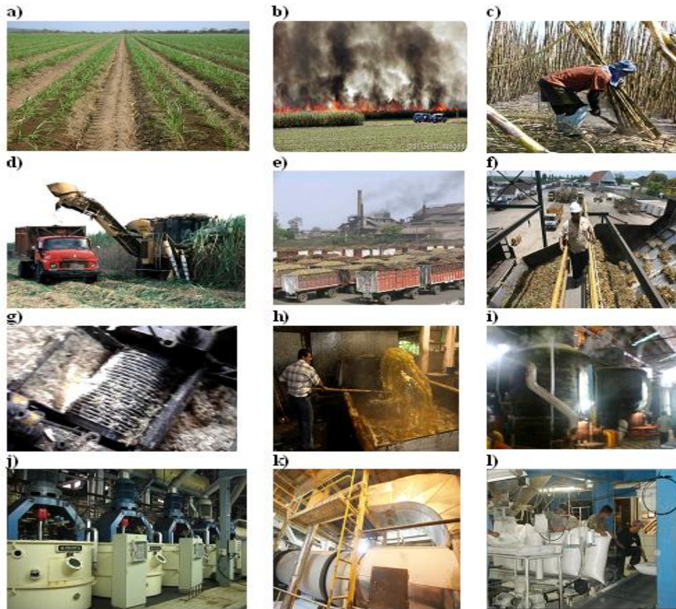
Fig. 4. Proceso de elaboración del azúcar. a) siembra; b) quema; c) cosecha manual; d) cosecha mecánica; e) transporte; f) troceado; g) molinos; h) clarificación; i) evaporación; j) centrifugación; k) secado l) envasado (Elaboración propia)
