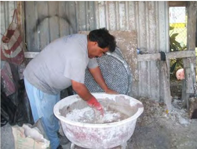
Foto 7. Preparación de pólvora en un taller de juguetería
