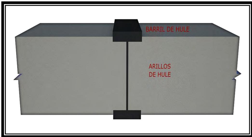
FIGURA 2.15 Unión en tuberías de asbesto-cemento.
