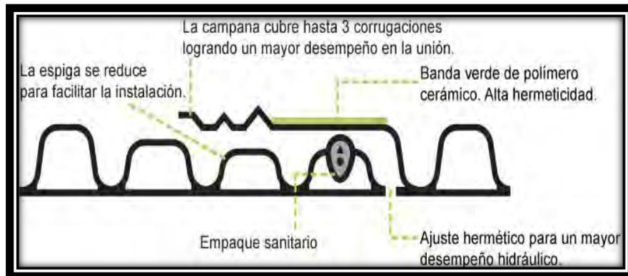
FIGURA 4.1 Tuberías para sistemas herméticos sanitarios, (Ref. 15)
