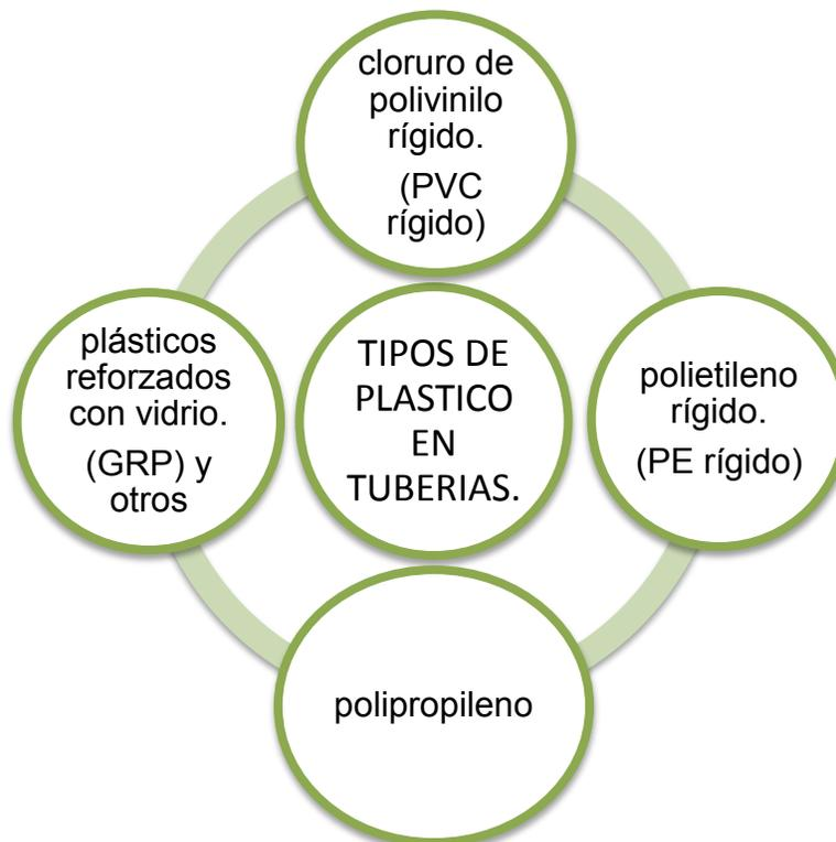
FIGURA 2.8 Tipos de plástico usados en tuberías para alcantarillado.
