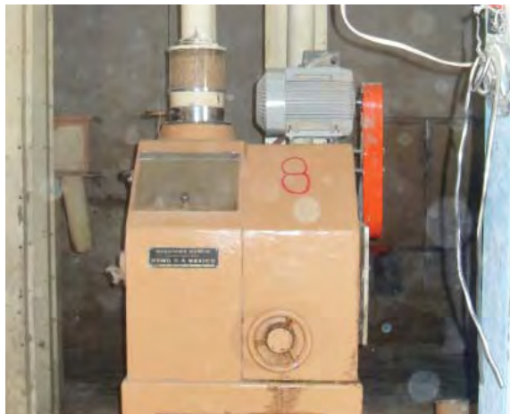
descascaradora en molino de arroz
