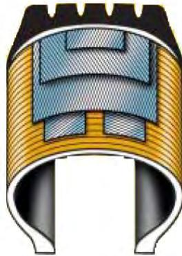
Figura A.2 Construcción radial
