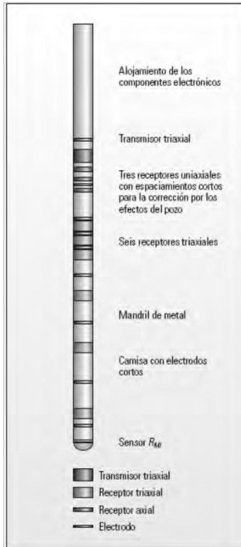
Fig. II.26. Esquema de una sonda de inducción triaxial<sup>14</sup>.
