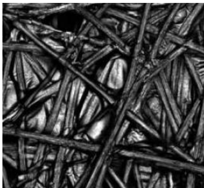
Fig. 1.10 Estructura del papel Toray. Imagen tomada de [1].
