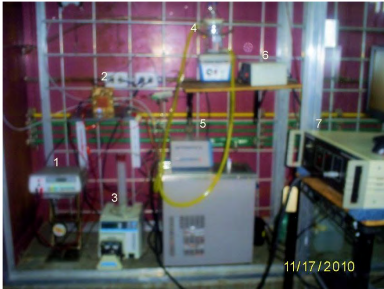
Fig. 2.3 Montaje del equipo utilizado en la prueba de la mono celda electroquímica en el laboratorio
