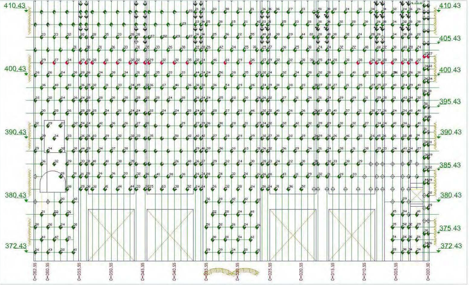
Figura 2.117.- Anclaje final en muro aguas arriba de galería de oscilación
