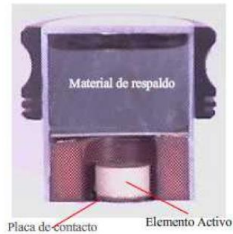
Figura 3.11: Ejemplo de configuración de un solo elemento.
