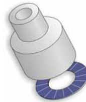
Figura 3.17: Transductor con arreglo anular sectorial.
