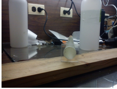
Figura 5.7: Corona para el arreglo 4 empotrada en la barra de Rexolite.
