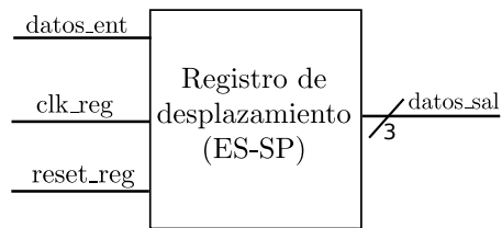
Figura 5.12: Registro de desplazamiento utilizado en la arquitectura del filtro Gaussiano.
