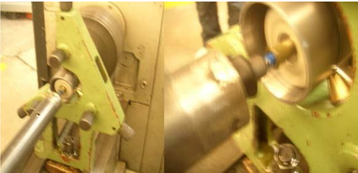
Figura 4.12 Rectificado de camisa con disco de diamante.
