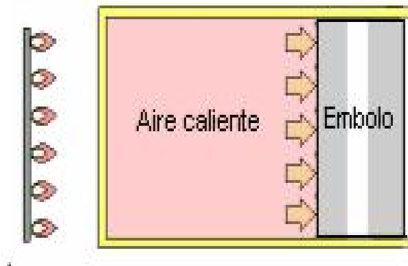
Fig.1.10 Calentamiento de aire dentro de un cilindro. (1)
