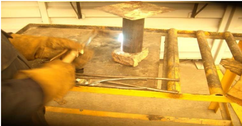
Figura 4.14 Proceso para dilatar cilindro de aluminio.
