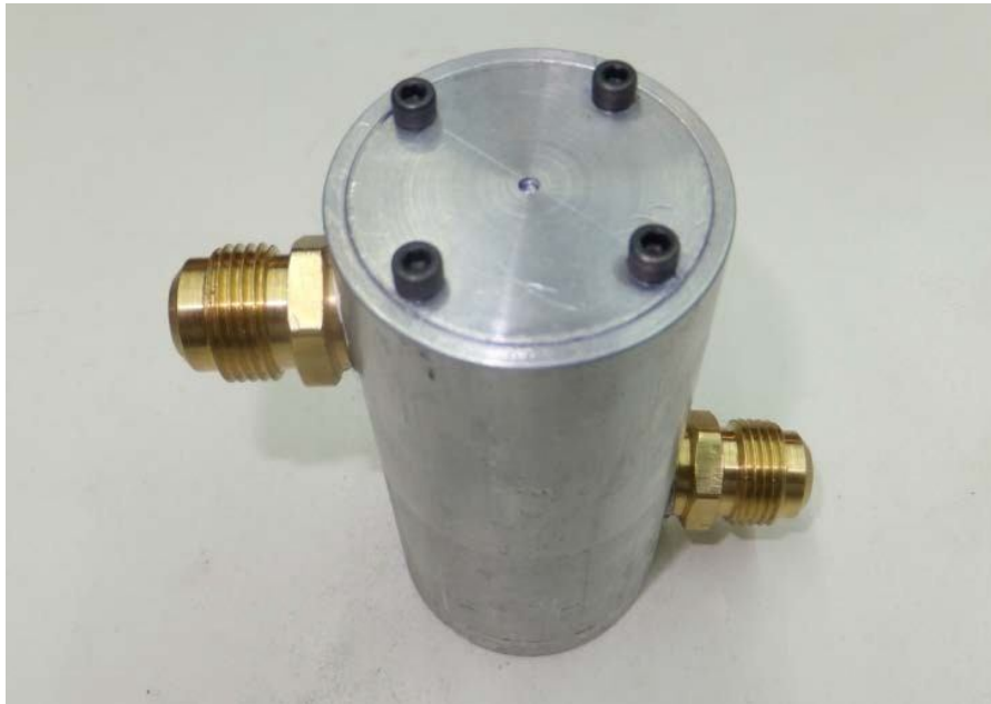
Figura 4.44. Maquinado final del regenerador.
