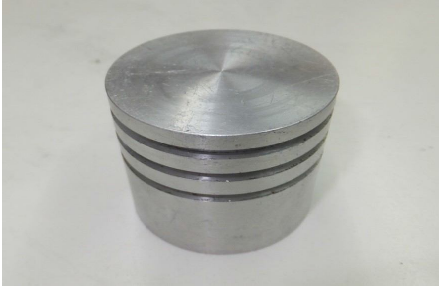
Figura 4.18 Maquinado del pistón en torno.
