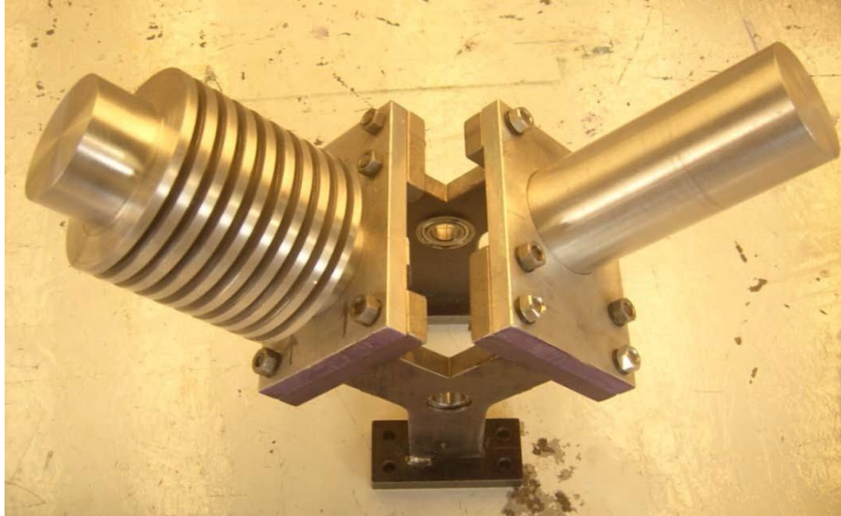
Figura 4.42. Arreglo de motor en “V” a 90°.
