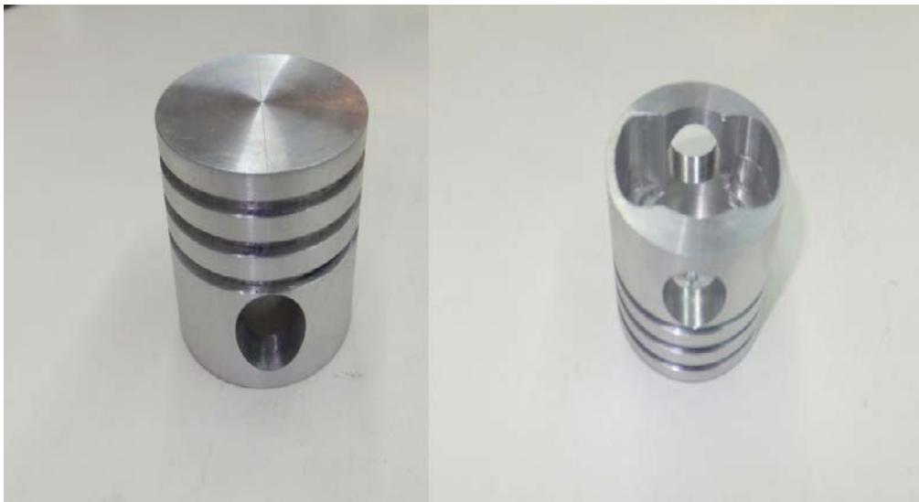
Figura 4.19 Maquinando final del pistón.
