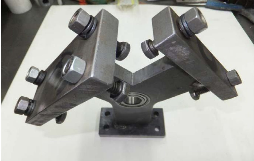
Figura 4.40. Maquinado final de la base del motor.
