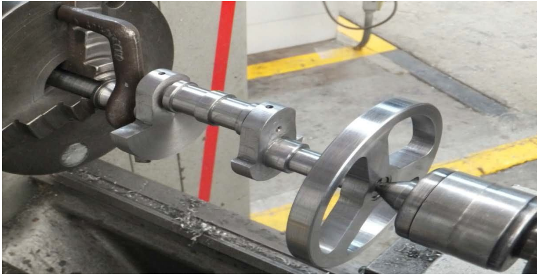
Figura 4.49 Ensamble del cigüeñal y volante de inercia.
