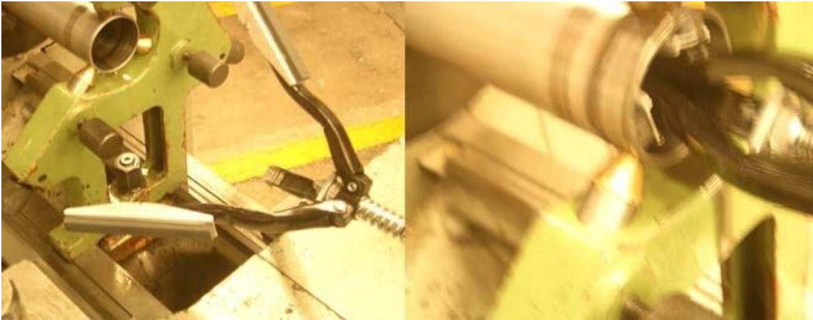
Figura 4.13 Pulido de pared interna con Bruñidor.
