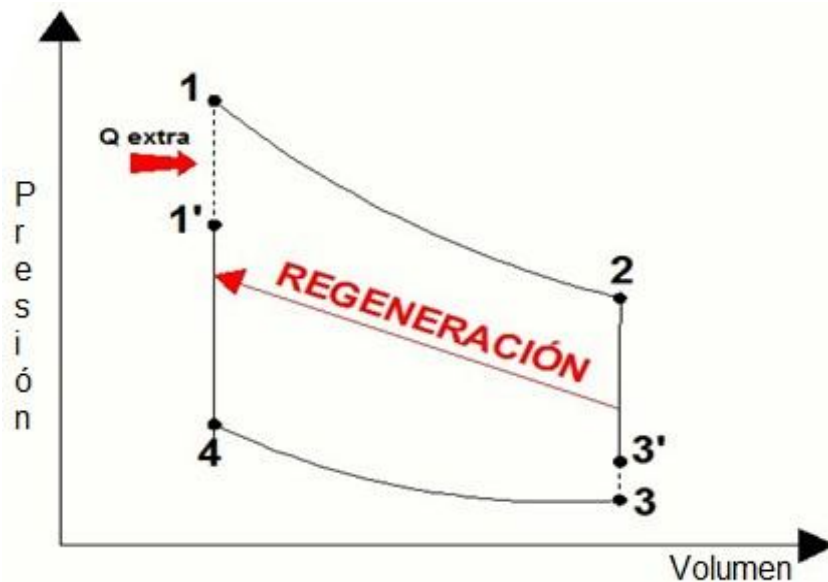
Figura 2.15 Efectos de la ineficiencia del regenerador.
