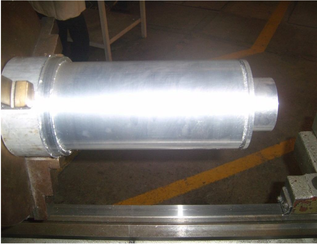
Figura 4.4 Tocho de aluminio para foco frio.
