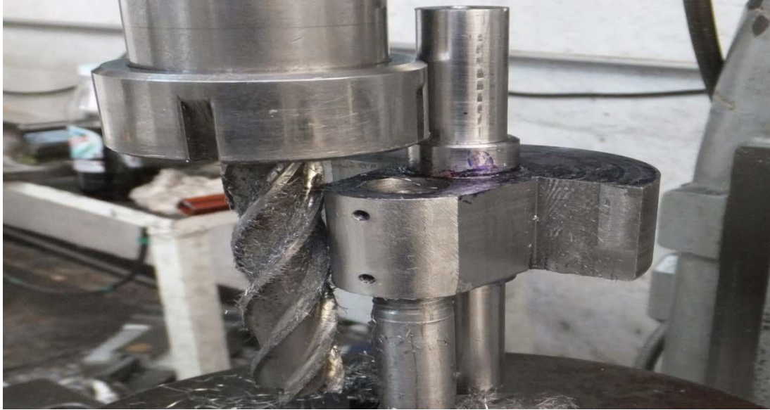
Figura 4.29. Maquinado de cigüeñal.
