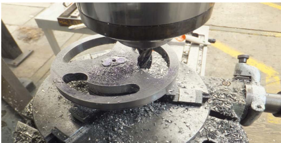
Figura 4.32 Fresado del volante.
