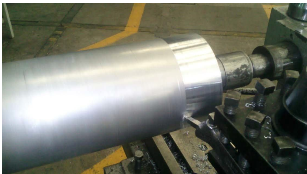
Figura 4.7 Maquinado del cilindro del foco caliente.
