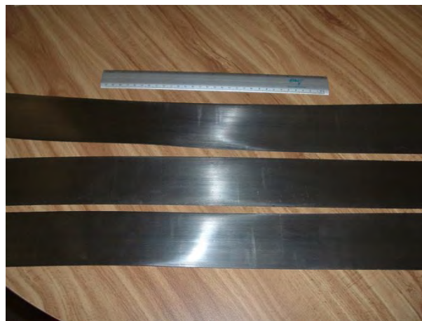
Figura. III-23 Acero IF después del proceso de laminación en frío con un espesor final de 0.5 mm, se aprecia un buen acabado superficial.
