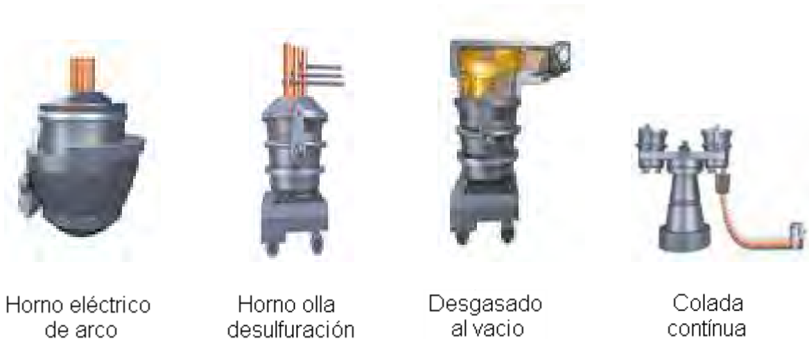
Figura. 1 Se muestra la ruta tecnológica desarrollada para la producción de aceros ultralimpios.
