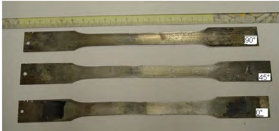
Figura III-50 Probetas ensayadas de tensión de acero IF recocido con cortes a diferentes ángulos (0° 45° 90°).
