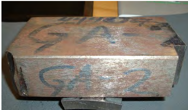
Figura.III.1 Placa identificada como G-2, se realiza la caracterización metalúrgica del acero en condición de colada continua.
