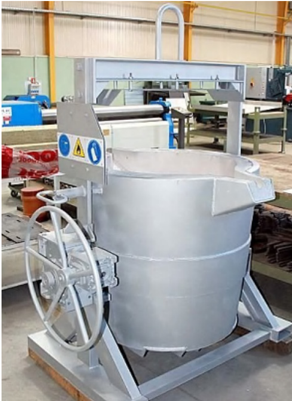
Figura 30. Reactor industrial para el desgasificado de aluminio [63, 64].
