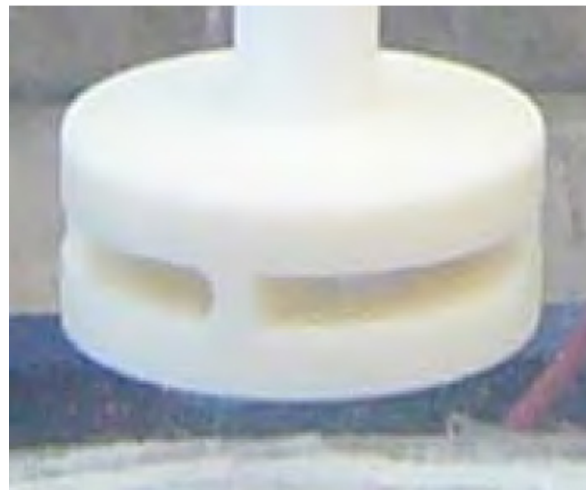
Figura 33. Rotor B fabricado en Nylamid [63].
