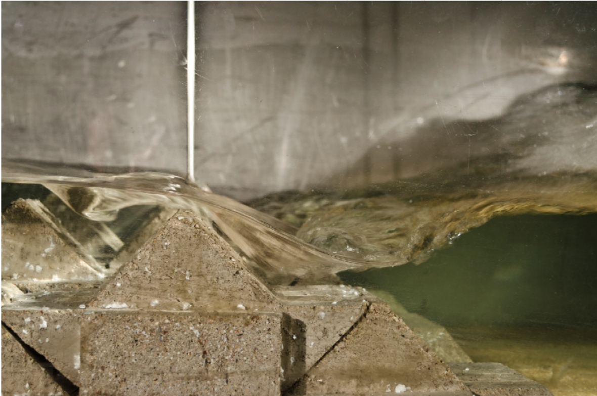
Figura 5. 4. Vórtices entre las crestas de las piezas.
