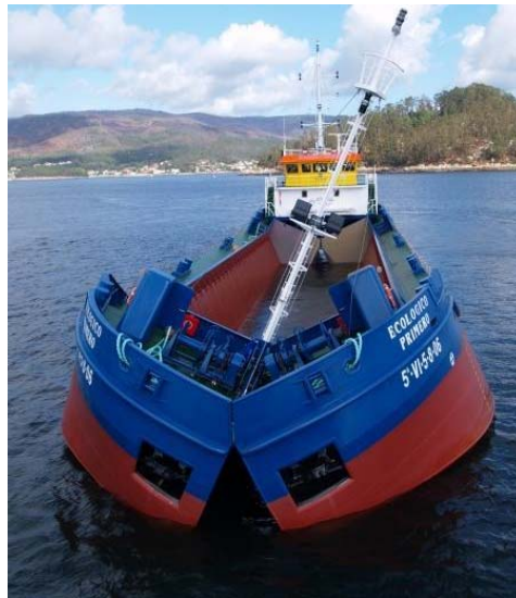
Figura 1. 9. Draga gánguil para la construcción de estructuras rompeolas.
