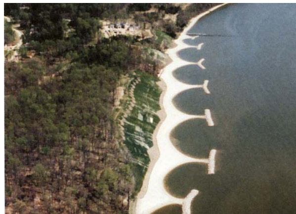
Figura 1. 8. Estructuras rompeolas y tómbolos generados.
