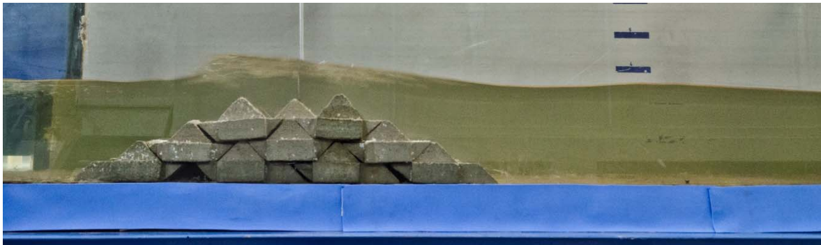
Figura 5. 6. Oleaje peraltado. H=4 cm, h=30 cm, T=1.549 s.
