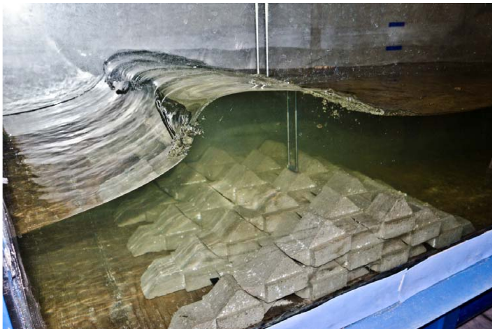
Figura 5. 10. Rotura del oleaje vista a detalle.
