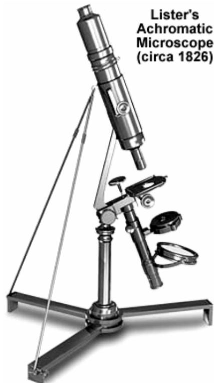
**Figura 4.-** Microscopio acromático diseñado y utilizado por Lister.
