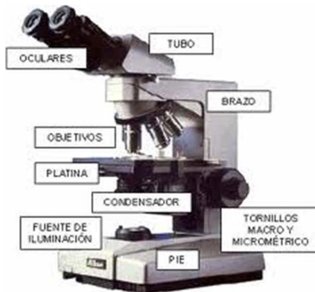
**Figura 5.-** Microscopio óptico.
