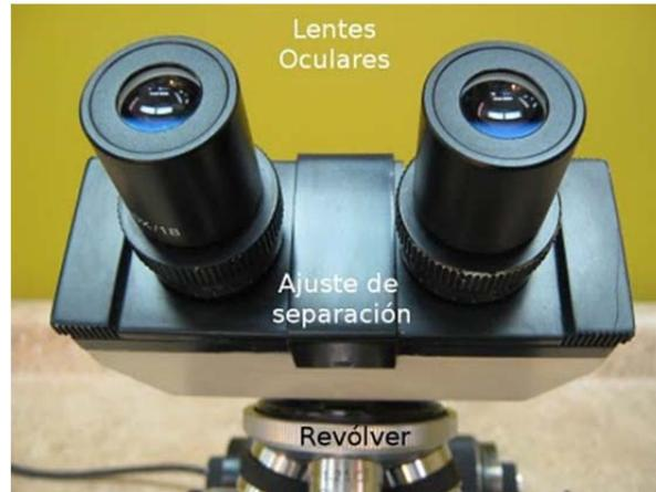
**Figura 6.-** Lentes de un microscopio óptico.
