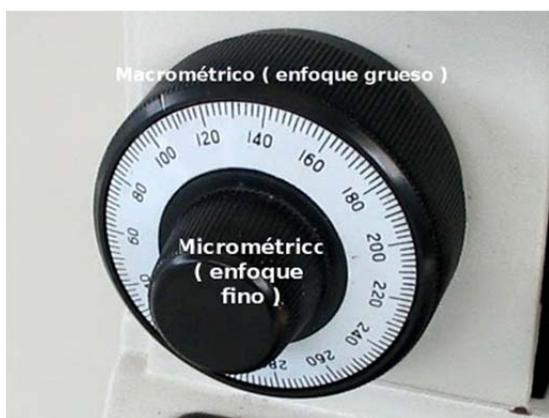
**Figura 14.-** Tornillo Micrométrico y Macrométrico.
