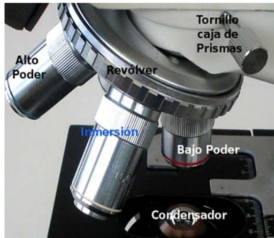
**Figura 7.-**Parte óptica de un microscopio. Lente Bajo Poder: Generalmente 4X
