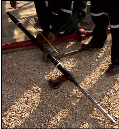
Figura 1.20. Conjunto Camisa y Bomba Jet del pozo Guaricho 501. 49
