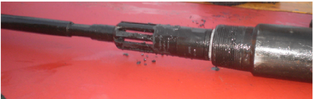
Figura 1.19. Camisa Deslizable y Bomba Jet del pozo Cactus 3. 49
