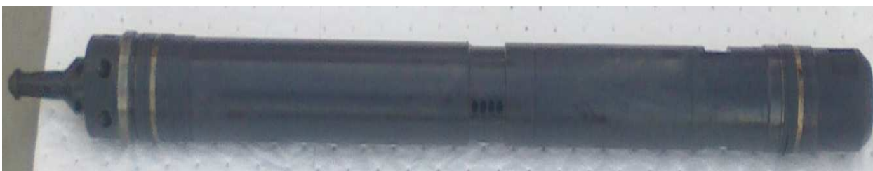
Figura 3.37. Bomba Subsuperficial Tipo Jet instalada en el Pozo Secadero 1001.
