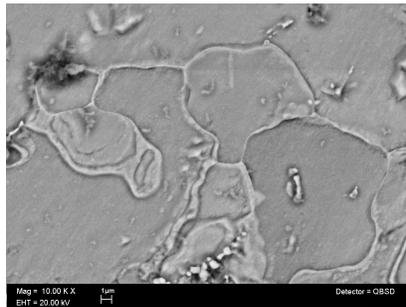
Figura 3.3: Acero AISI 1018, Atacada con Reactivo Nital, Amp. 10000x
