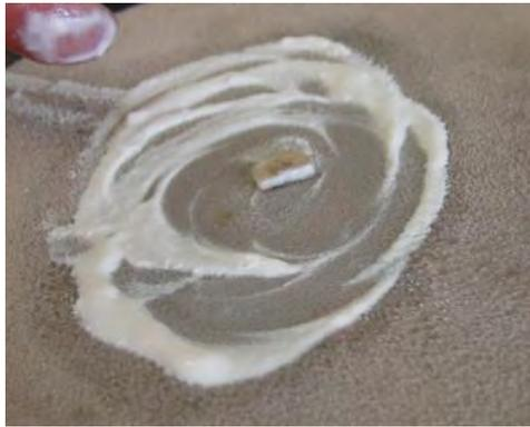
Figura IV.7 Pulido de la muestra para obtener superficie en espejo.
