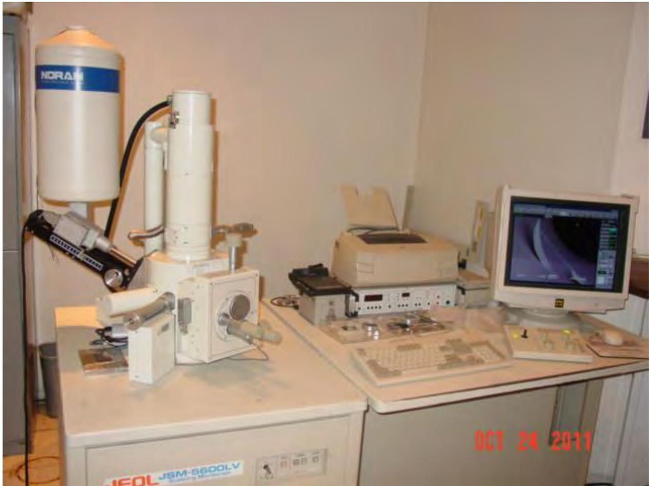
Figura III.2. Microscopio electrónico de barrido.
