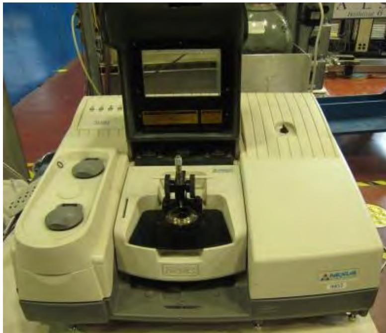
Figura III.4. Espectrómetro Nicolet NEUX 470.
