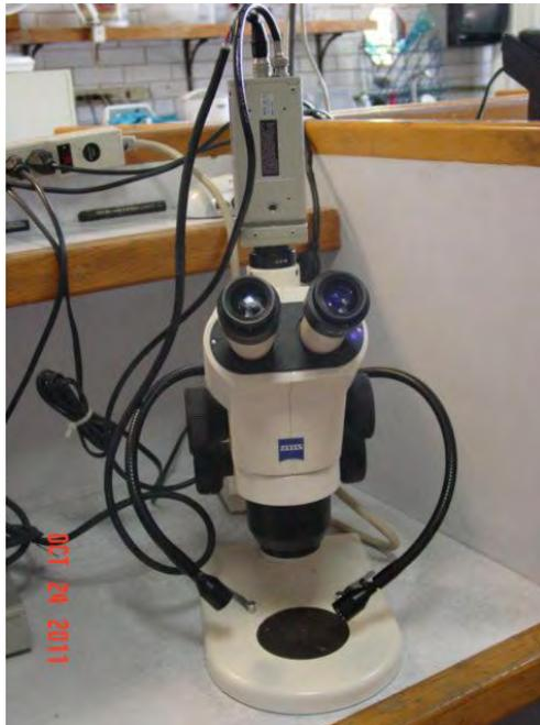
Figura III.1. Microscopio de luz de la marca Zeiss.
