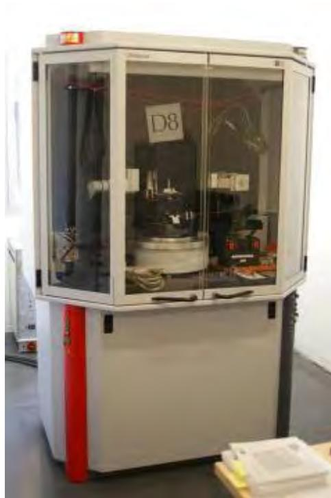
Figura III 3. Difractómetro BRUKER, modelo D8-ADVANCE.
