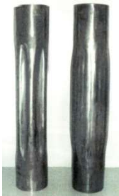
Figura 3.4 Tubería antes (izq.) y después (der.) de la expansión con agua
