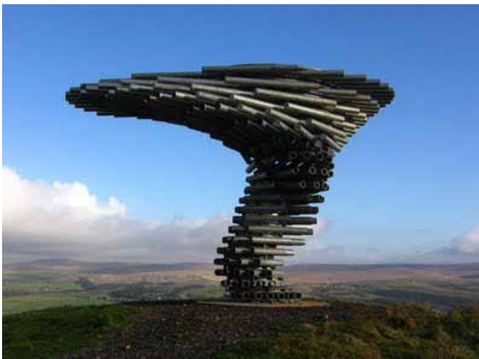
67. Singing ringing tree es una escultura sonora, construida en Inglaterra, a partir de tubos de acero galvanizado que utiliza la fuerza del viento para producir sonidos que varían dependiendo del largo de los tubos y abarcando varias octavas
