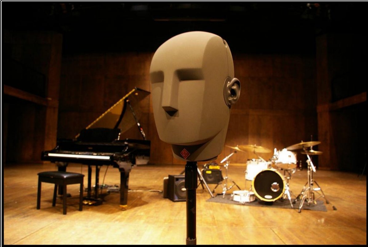
Figura 2.1 'Dummy head' de la marca Neuman, producto comercial para la generación de audio tridimensional basado en esta técnica.
