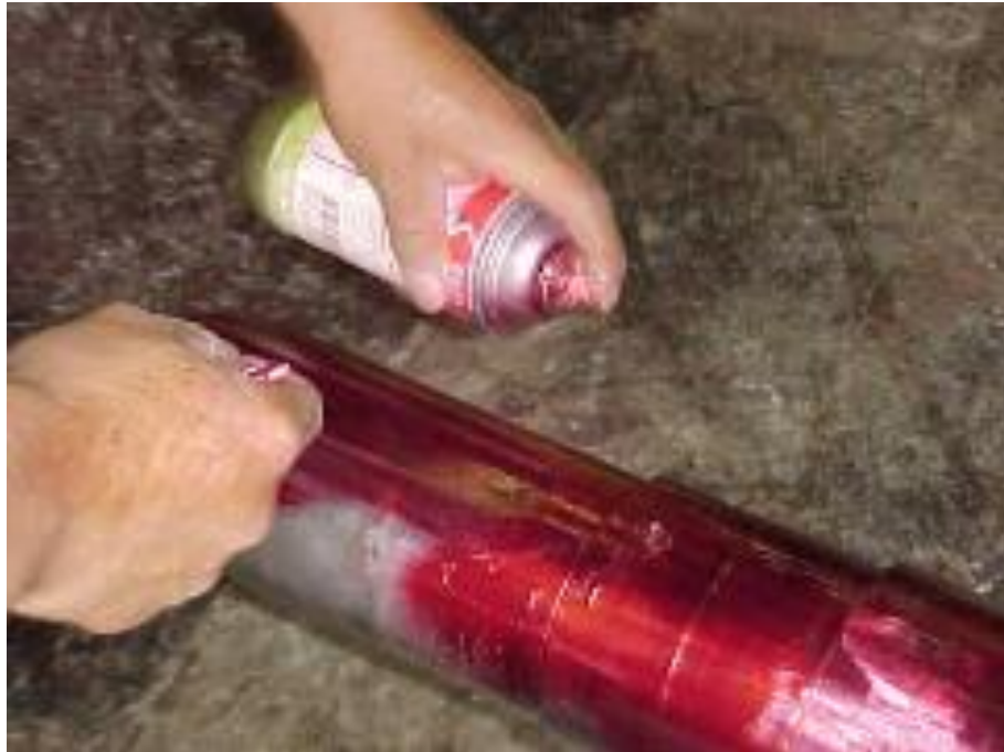
Figura 2.13. Aplicación de la técnica de líquidos penetrantes visibles.
