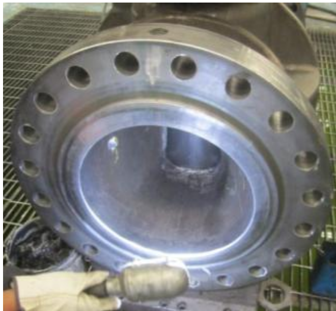
Figura 2.4. Válvula macho con asiento lubricado.
