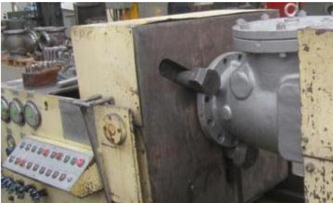
Figura 2.15. Prueba hidrostática de casco en una válvula de retención.
