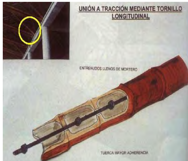
Empleo en un caso práctico de una unión con mortero
