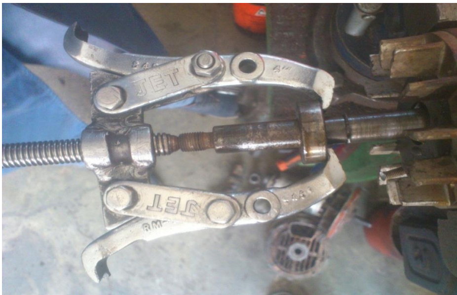
Figura 62.- Extracción del balero delantero, planta Liconsa Norte. Fotografía tomada con permiso de la administración (22 septiembre 2012)
