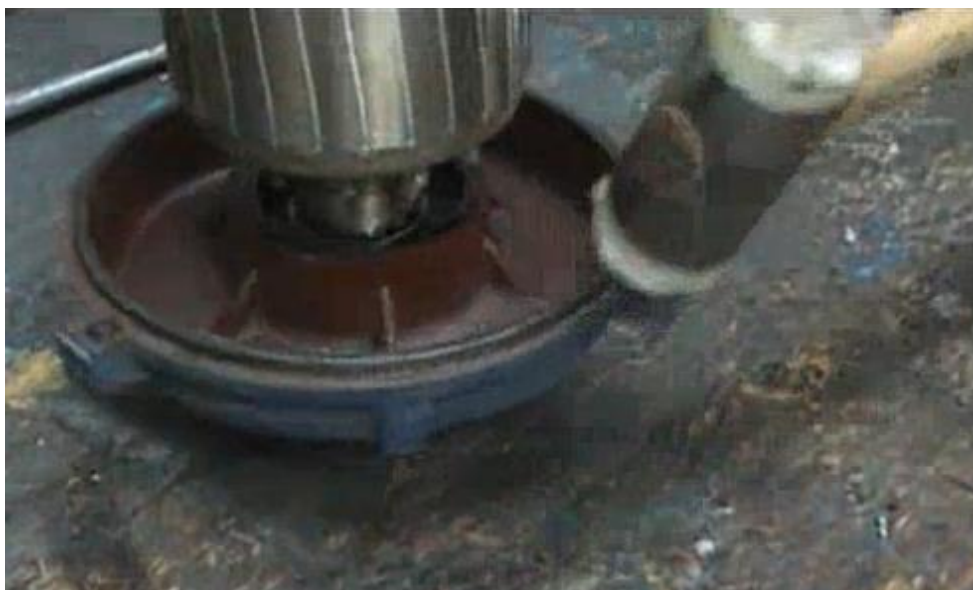
Figura.- 57 Extraer tapa del eje del rotor, planta Liconsa Norte. Fotografía tomada con permiso de la administración (22 septiembre 2012)
