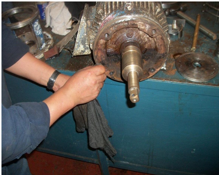
Figura.- 50 Verificación del porta flechas estándar y limpieza, planta Liconsa Norte. Fotografía tomada con permiso de la administración (22 septiembre 2012)
