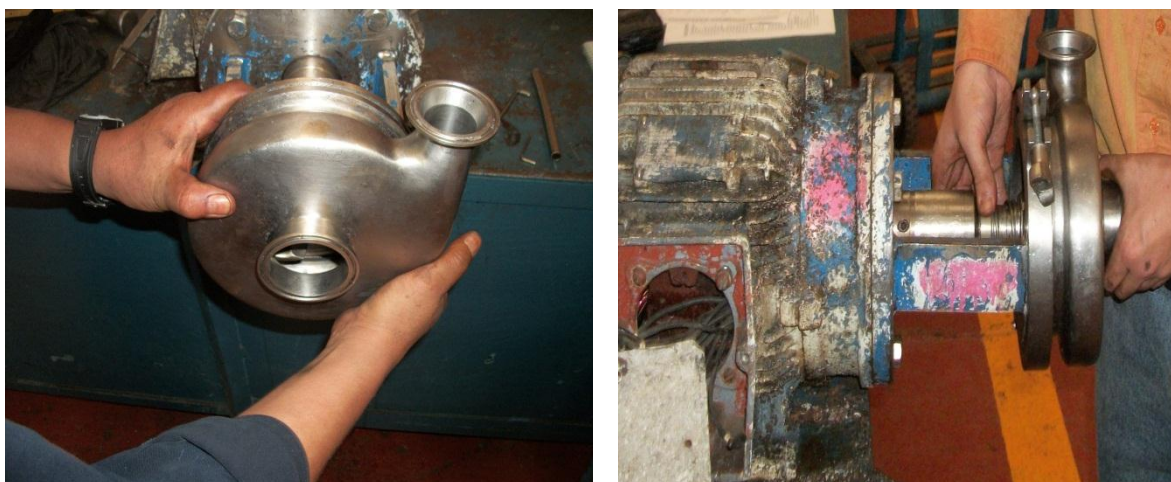
Figura 78 y 79.- Colocación de la carcasa, planta Licónsa Norte. Fotografía tomada con permiso de la administración (22 septiembre 2012).
