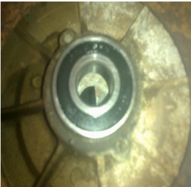
Figura.- 58 y 59 Colocación del balero de la tapa trasera, planta Liconsa Norte. Fotografía tomada con permiso de la administración (22 septiembre 2012)
