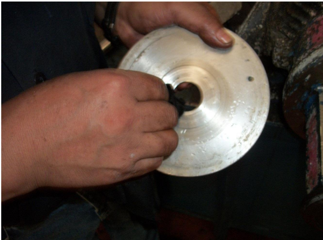
Figura.- 48 Verificación del sello de la carcasa y plato, planta Licónsa Norte. Fotografía tomada con permiso de la administración (22 septiembre 2012)
