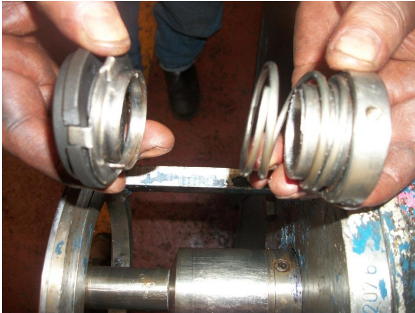
Figura.- 49 Verificación del sello mecánico, planta Liconsa Norte. Fotografía tomada con permiso de la administración (22 septiembre 2012)
