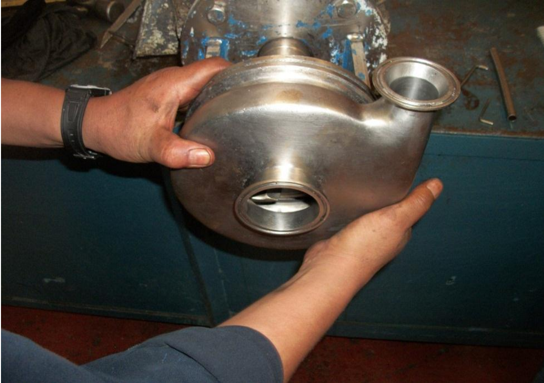
Figura.- 45 Desmontaje Carcasa, planta Liconsa Norte. Fotografía tomada con permiso de la administración (22 septiembre 2012)
