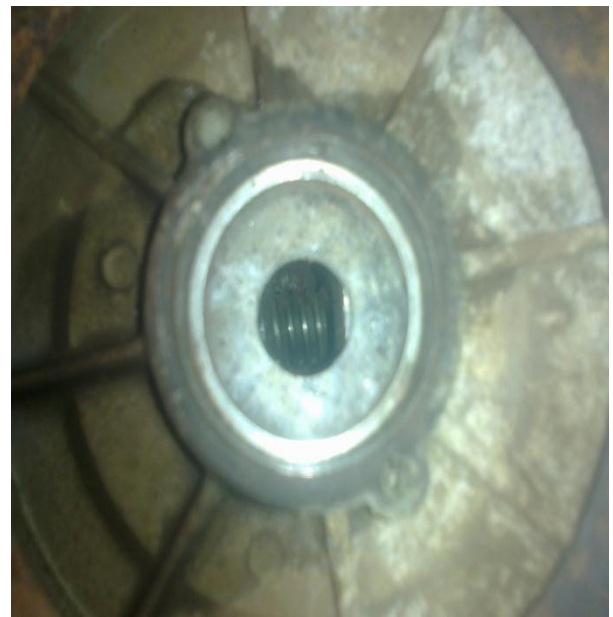
Figura.- 58 y 59 Colocación del balero de la tapa trasera, planta Liconsa Norte. Fotografía tomada con permiso de la administración (22 septiembre 2012)
