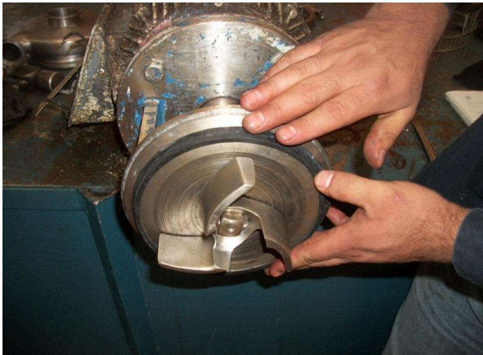
Figura 77.- Colocación del empaque de la carcasa, planta Liconsa Norte. Fotografía tomada con permiso de la administración (22 septiembre 2012).
