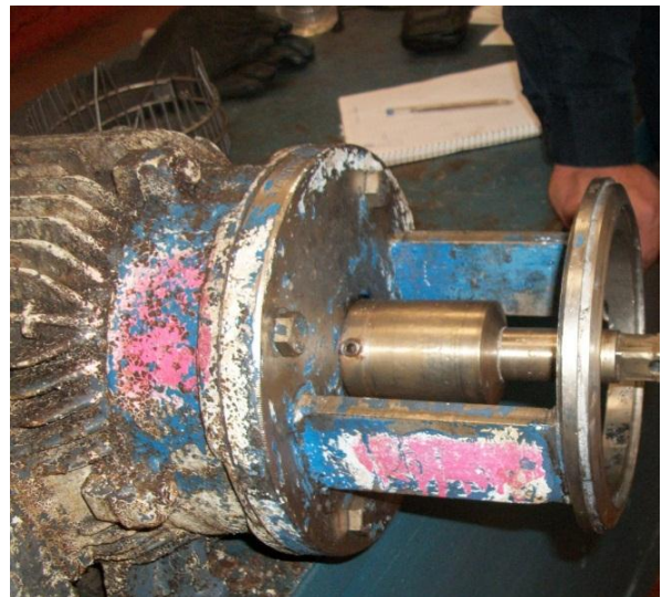
Figura 70 y 71.- Colocación del adaptador metálico, planta Liconsa Norte. Fotografía tomada con permiso de la administración (22 septiembre 2012).
