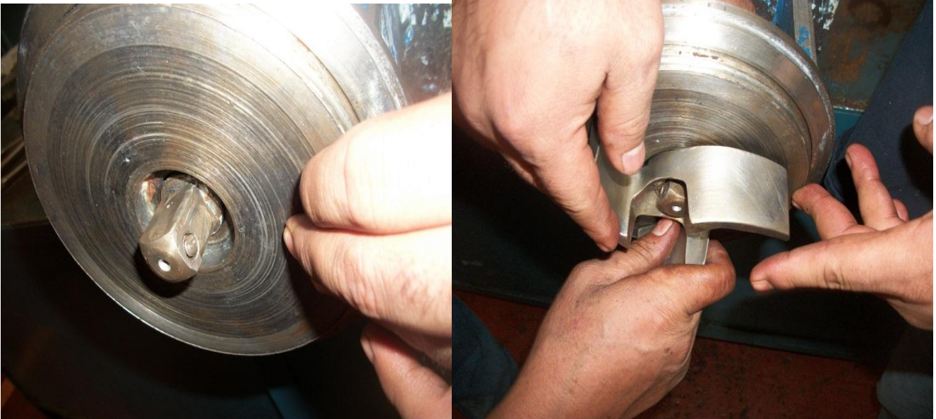
Figura 75 y 76.- Colocación del impulsor sello mecánico, planta Liconsa Norte. Fotografía tomada con permiso de la administración (22 septiembre 2012).
