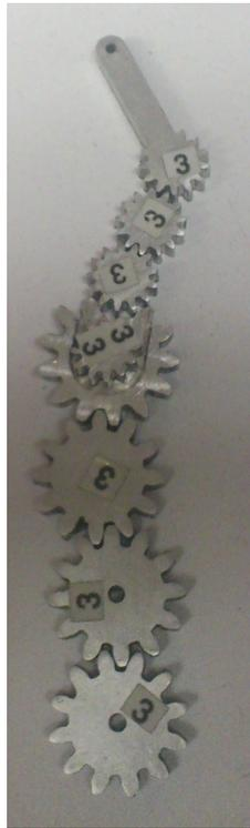
Figura 7.8: Mecanismo corte por chorro de agua.
