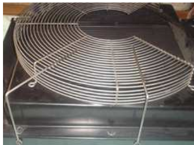
Fig. 2.2 Protección en radiador
