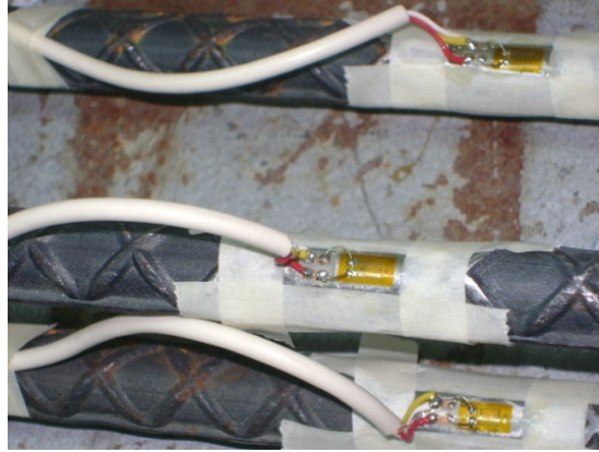
Figura 15 Habilitado de los extensómetros sobre las barras de refuerzo
