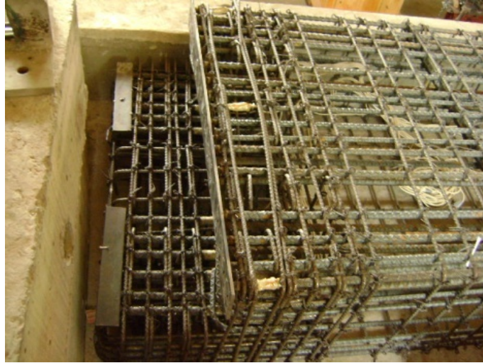
Figura 17 Especímen E1 y su refuerzo (correspondiente a las mismas consideraciones en armado que las del prototipo)
