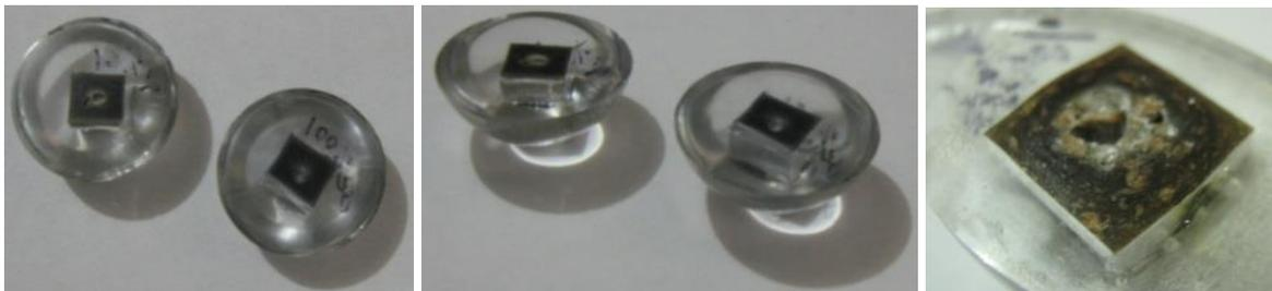
Fig. 5.45. Probetas preparadas para su observación en el MEB.
