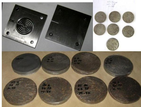
Fig. 4.13. Probetas elaboradas para el ensayo de dureza en el material compuesto.
