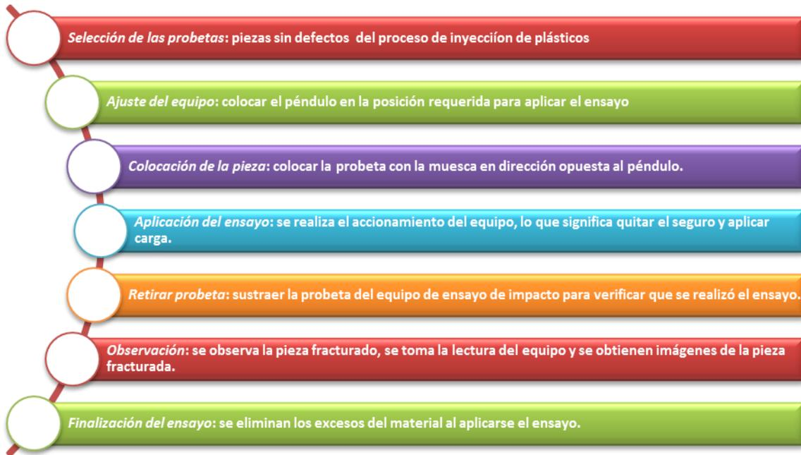
Fig. 5.3. Secuencia de etapas para el ensayo de impacto
