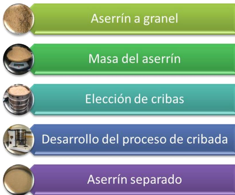
Fig. 5.11. Proceso para la separación (cribado) del aserrín de pino
