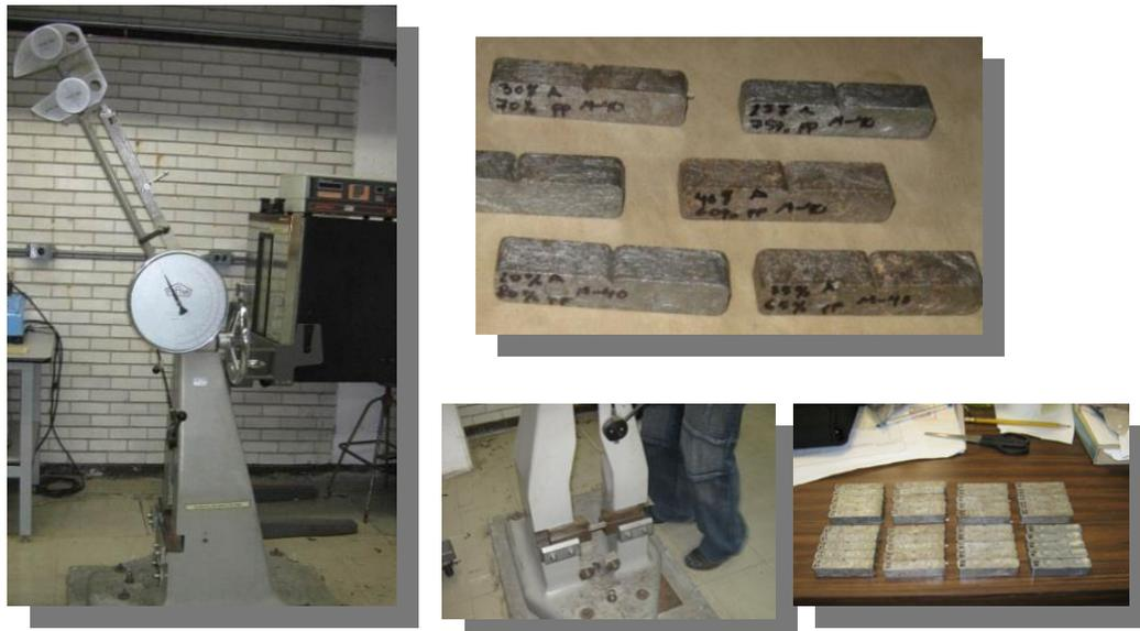
Fig. 5.4. Equipo de impacto, probetas para el ensayo
