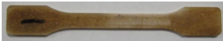
Fig. 4.11. Probeta 80% polipropileno y 20% aserrín
