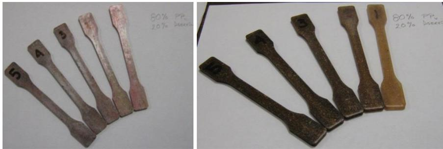
Fig. 4.10. Probeta fabricada con polipropileno reciclado y aserrín
