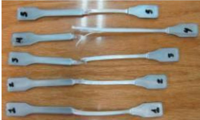
Fig. 5.19. Probetas ensayadas de material (PP) reciclado
