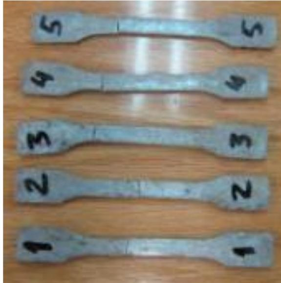
Fig. 5.21. Probetas de composición 60-40 [%], luego de ser sometidas al ensayo de tracción.
