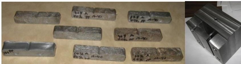
Fig. 4.12. Probetas elaboradas para el ensayo de impacto
