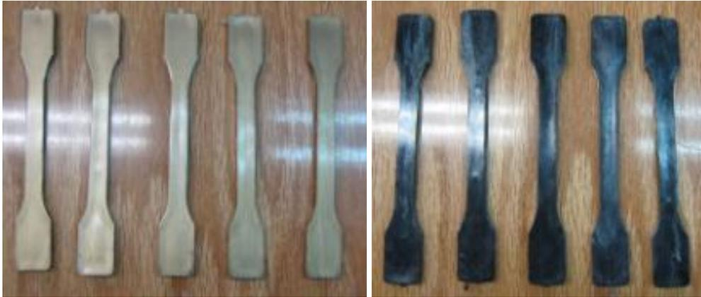
Fig. 5.17. Probeta de tracción con polipropileno reciclado sin refuerzo.
