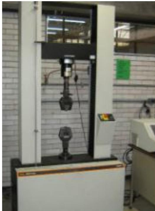
Fig. 5.18. Máquina Universal Instron modelo 4206 de 150 kN para el desarrollo del ensayo de tracción.
