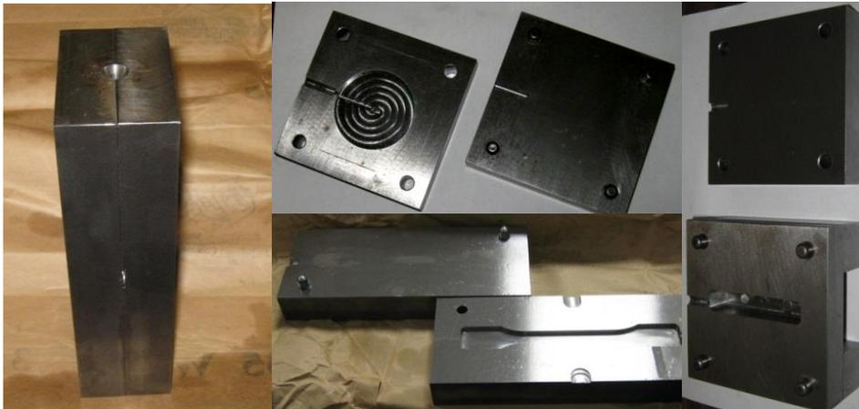
Fig. 4.6. Molde fabricado para las probetas de ensayos mecánicos
