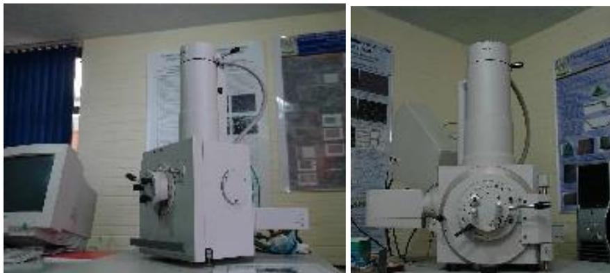
Fig. 5.8. Microscopio electrónico de Barrido XL20
