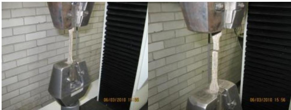
Fig. 5.16. Detalle del ensayo de tracción para las probetas de materiales compuestos PPreциado-A
