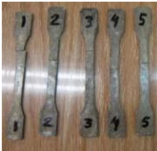
Fig. 5.20. Probetas de material compuesto después del ensayo de tracción con una composición de 90-10 [%].
