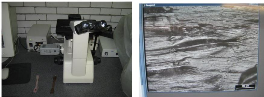
Fig.5.38. Microscopio óptico y una imagen del material de PP virgen reciclado obtenida con el equipo
