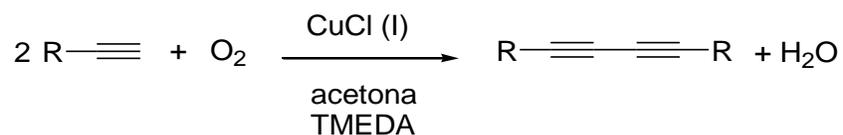
Figura 2.3.1.3.- Reacción de acoplamiento propuesta por Hay.
