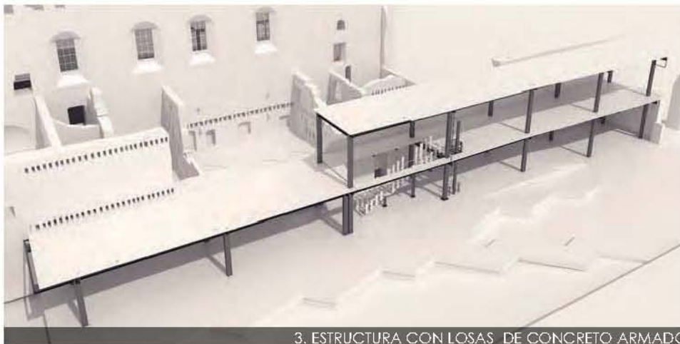
3. ESTRUCTURA CON LOSAS DE CONCRETO ARMADO
