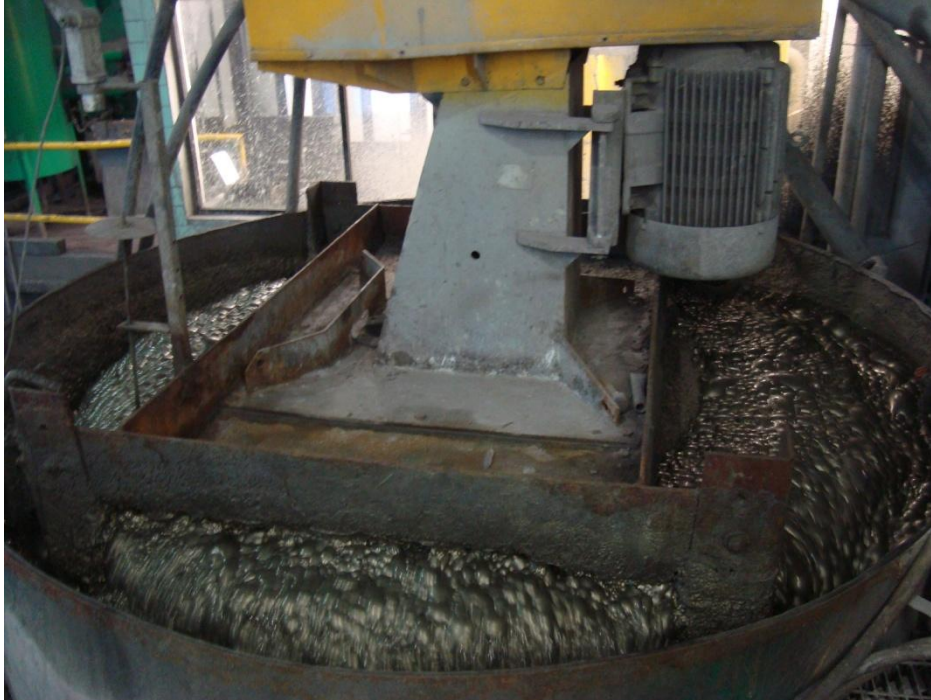
Figura 2.3 Imagen de una celda de flotación enfatizando la espuma. Cortesía de la Cía Minera “La Negra”, Maconí, Qro.
