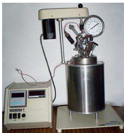
Figura 28. Equipo de reacción utilizado (reactor Parr a alta presión)
