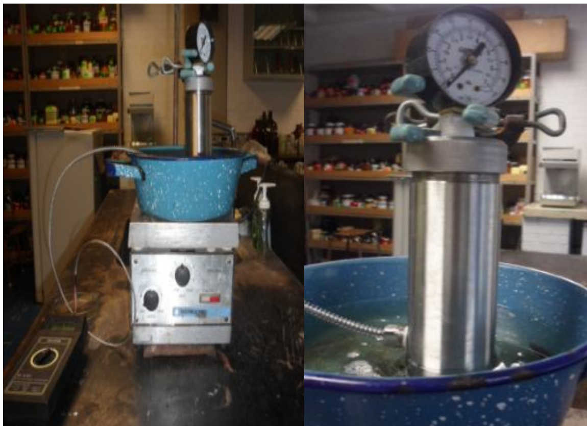
Figura 4. Reactor diseñado para las pruebas de temperatura y presión.
