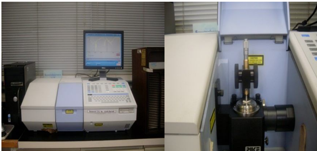
Fig. C1 Espectrofotómetro de infrarrojo por transformada de Fourier "PERKIN ELMER FT-IR, Spectrometer, Spectrum RX I".
