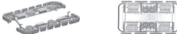
Figura. 2-37 Válvula con cuatro conexiones en serie de módulos de tiristores y reactancias.
