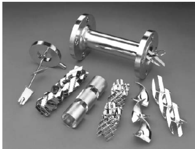
Figura 3.8: Opciones de diseño de mezcladores estáticos. De izquierda a derecha: mezclador de vórtice (tipo KVM), platos corrugados (tipo SMV), paletas montadas en la pared (tipo SMF), barra cruzadas (tipo SMX), hélice girada (tipo KHT), barra cruzada (tipo SMXL) (Paul et al. , 2004).
