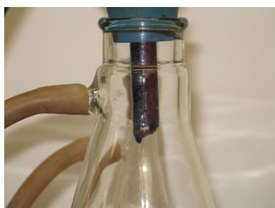
(e) Filtrado de aguas madre
