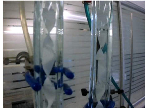
(b) Aspecto del mezclador ya montado en los intercambiadores de calor.
