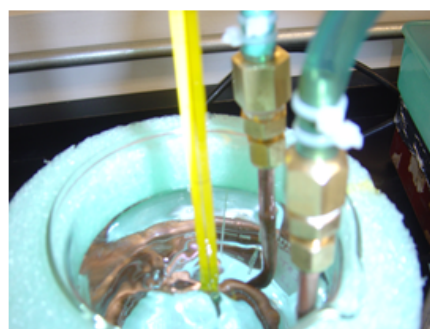
(c) Pruebas serpentín construido.
