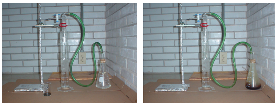
(a) El proceso requiere baño de hielo. (b) Se aprecia gas verde característico del gas cloro.
