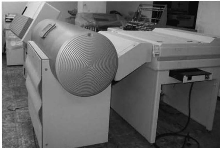
Filmadora y procesadora en línea para película modelo 4 Press de la marca Scitex
