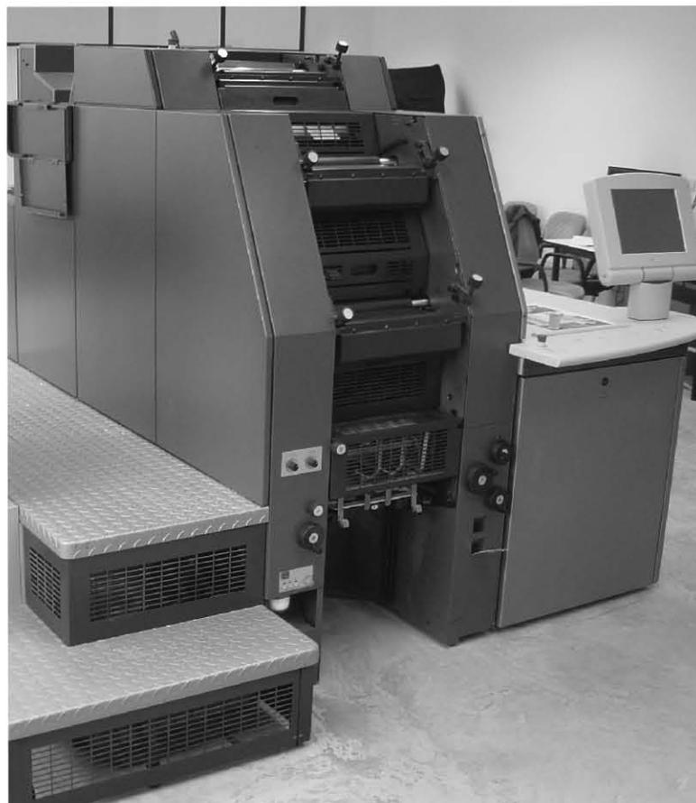
Máquina de offset digital modelo Speed Master de Heidelberg 4 colores con placas de silicón
