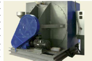
Motor situado en sitio accesible para un fácil mantenimiento
