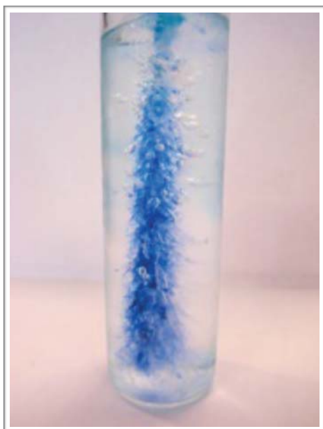
Imagen 52. Vial que presentó la reconstrucción de un complejo azul al ser congelado.
