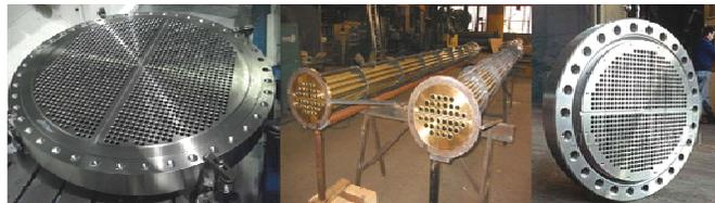
**FIGURA 1. 10 Placa de tubos o espejos**
