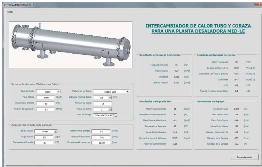
FIGURA 5. 8 Plataforma central del programa para el diseño de un intercambiador de calor de tubo y coraza
