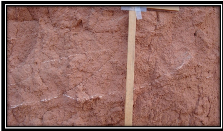
Figura 2.43 Limolita de color rojo con vetillas de calcita de la Formació Huajuapan, que aflora sobre la carretera, entre los poblados La Unión y Tezoquipan, Puebla.
