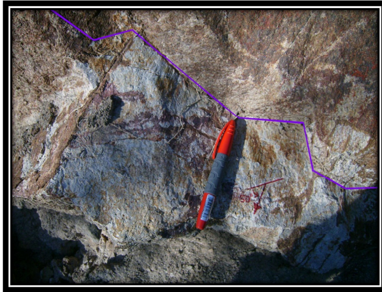
Figura 3.17 Falla lateral izquierda, con rumbo N25°E; 68° y un pitch de 50°, sobre la Barranca La Mina, perteneciente a la Formación Tecamazuchil.
