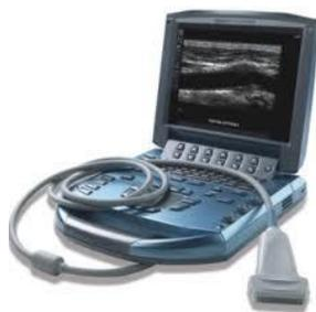
Figura 13. Ultrasonido portátil Sonosite
